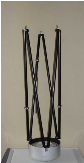
鍋底に支柱の取り付け
