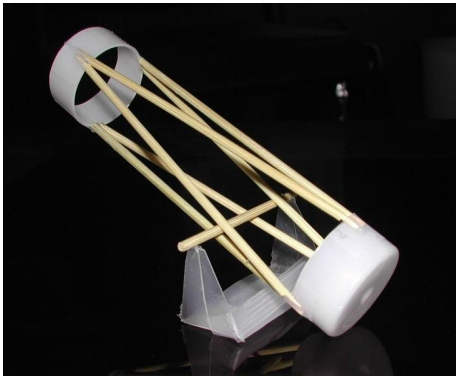
1/8 ダミー (材料はフィルムの缶と焼き鳥の竹串)
