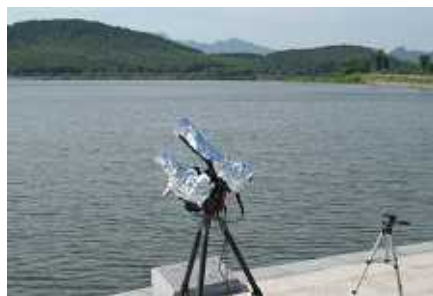
アルミホイルで機材の日除け
